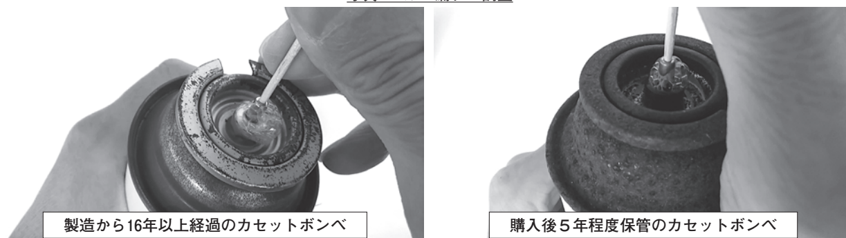
写真1. ガス漏れの調査
